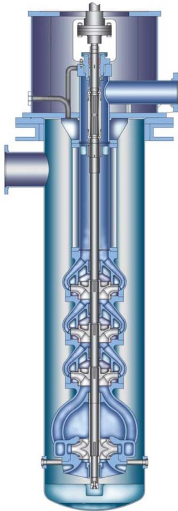
立式多级凝结水泵结构图
